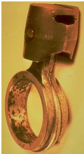
Figura 90 Daño en el Pistón por Retorno de Líquido al Compresor
