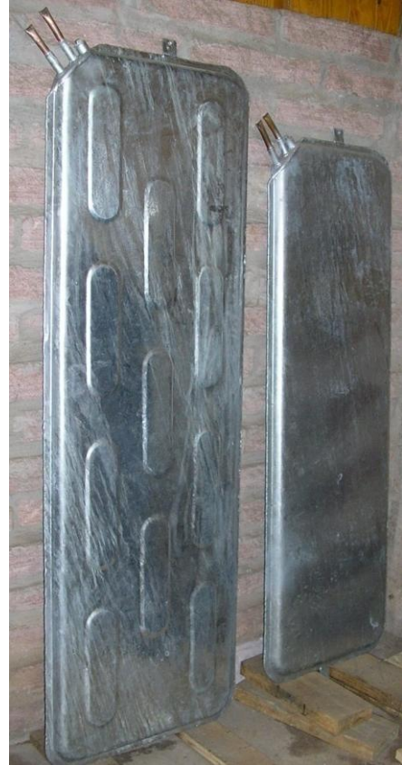
Figura 114 Uso de Placa Eutéctica en Transporte
