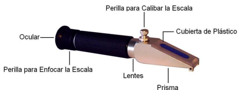
Figura 44 Refractómetro
