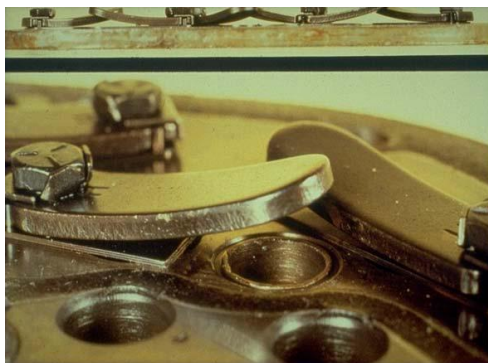
Figura 93 Daño en Válvulas
