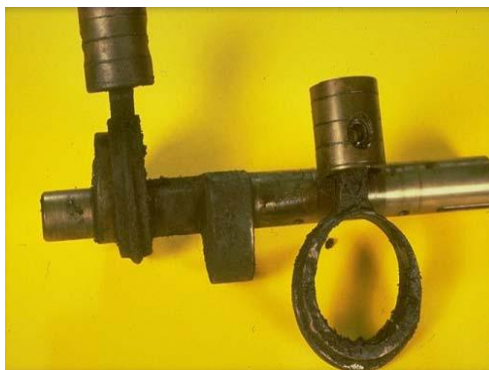
Figura 87 Daños en Bujes
