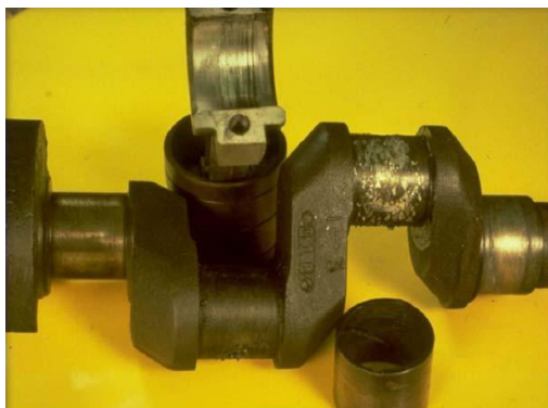
Figura 86 Desgaste por Falta de Lubricante
