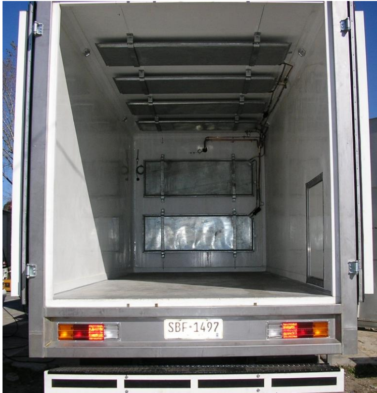
Figura 114 Uso de Placa Eutéctica en Transporte
