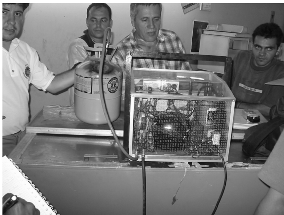
Figura No. 6 Prueba de recuperación de refrigerante R-12
